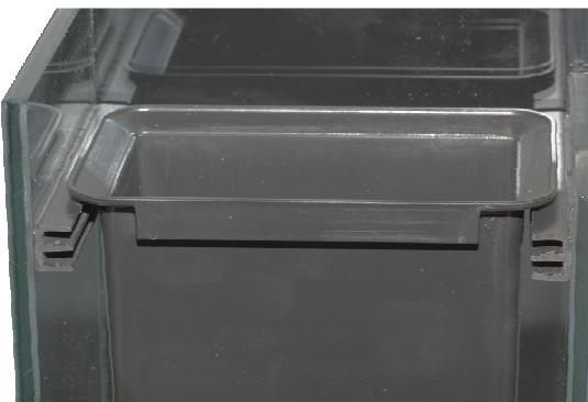
Der Filterkorb wird, wie in der Abbildung zu sehen, von oben in das Halteprofil eingehängt. Auf diese Weise ist er jederzeit herausnehmbar. Die Rückwand muss dazu nicht entfernt werden.
